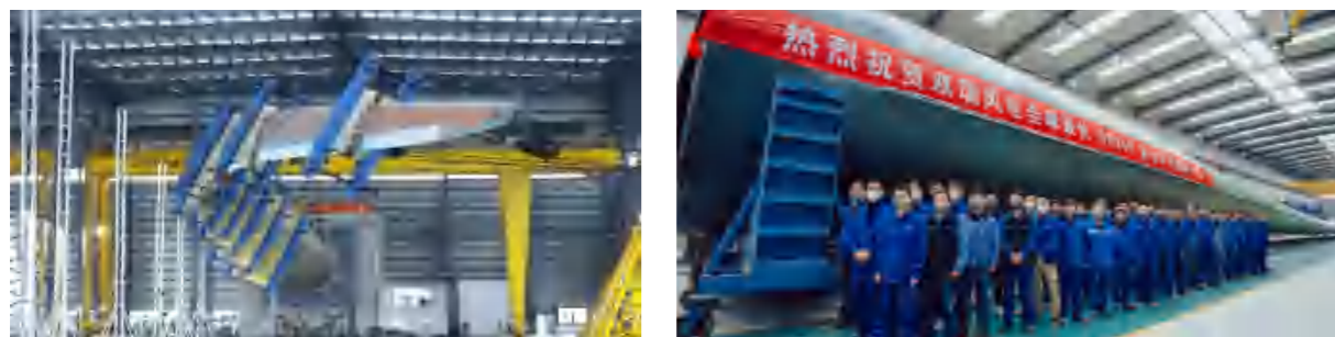
洛阳双瑞研发的叶轮直径达到 260 米的全球最长的 SR260 叶片，顺利通过静力测试，并在江苏盐城基地正式下线。
